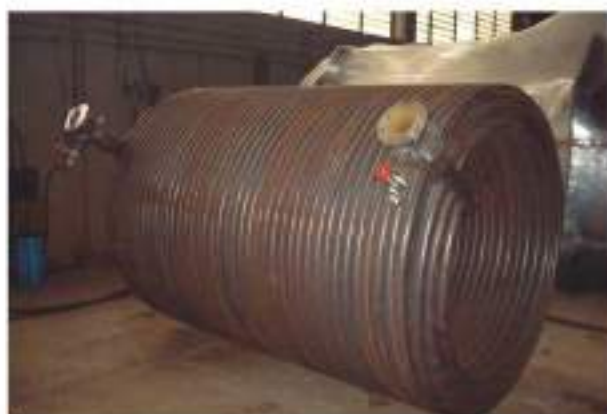
Fascio tubiero elicoidale di un generatore a recupero (Garioni Naval SpA)
