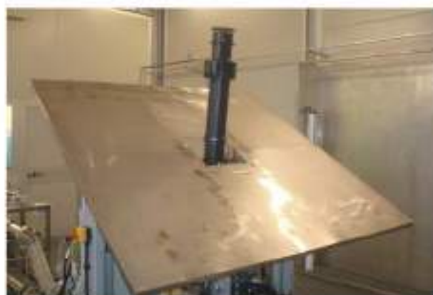
Terminale di scarico installato sulla tavola portapezzo che simula la falda del tetto
