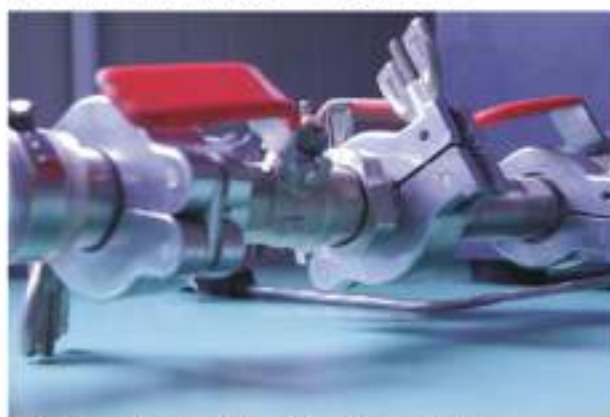
Particolare della linea di presa del contatore di particelle ELPI
