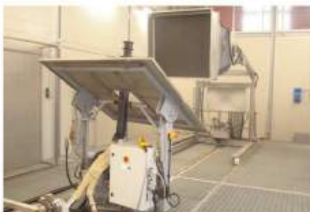
Terminale di scarico di una caldaia in prova nella galleria del vento wind_box
