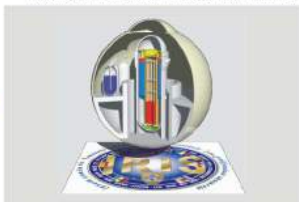
Reattore IRIS con schema del generatore di vapore
